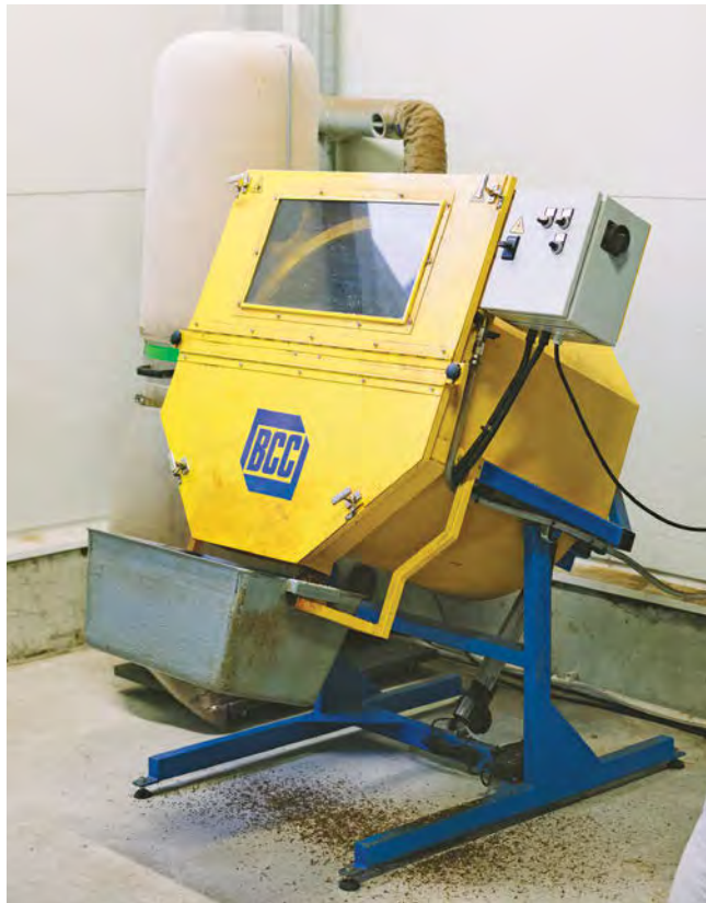
Sellises seadmes eraldatakse seemnetelt lennutiib.
