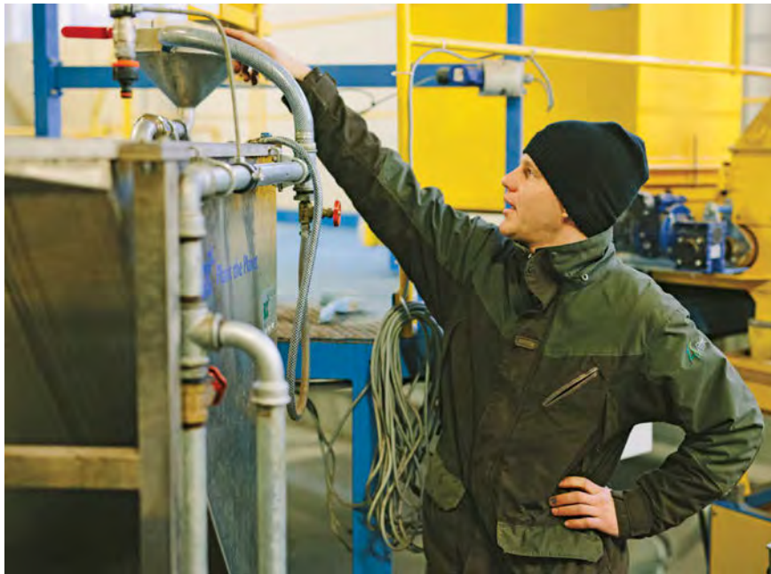
RMKseemnemajandusetöőjuht Lauri Saaparnäitab seadet, milles okaspuuseemneid pestakse. Katkise kestaga seemned vajuvad siin põhja, terved seemned uhutakse sõelaga kasti.
