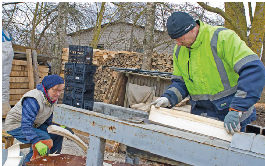
Laastumasina taga on Kalev Möttus, abiks Vaike Tamm, kelle ülesandeks on välkkiirelt välja sorteerida praaklaastud.
