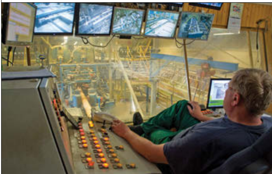
AS Toftani tootmisettevõtte süda on saehallis, kus operaatori ülesandeks on arvutiekraanidel jälgida palkide liikumist.
