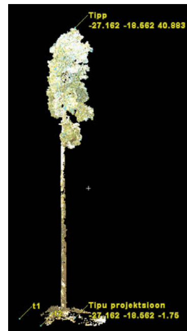
Järvelja tamme (A) ja kõrge männi (B) laserskaneerimise punktipilv. Punktipilvele on skanneriga tehtud fotode põhjal omistatud enam-vähem realistlikud värvid.
