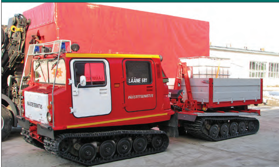
Rootsi riigilt abina ja meie kaitsevält kingituseks saadud ning päästeameti näpunäide järgi ringi ehitatud roomiktransportöör Bandwagen võtab peale kuni 1400 kg kaaluva taara ja sõidab sellega mööda sihti metsa.
