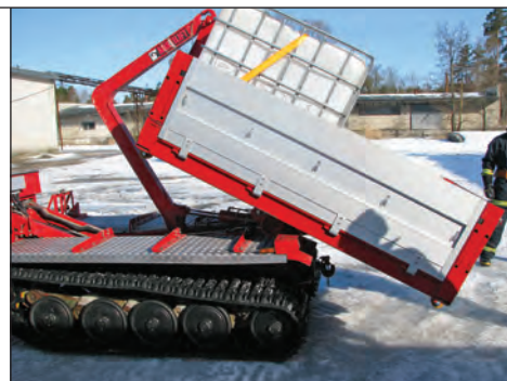
Bandwageni unikaalne tõstesüsteem kujutab endast tõstukiga kasti, mida on võimalik Bandwagenilt eemaldada ja mis saab töötada iseseisva punktina, ilma roomikmasinata.
