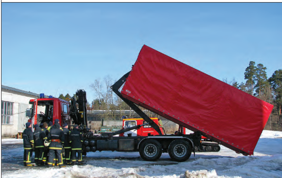
Suurele autole mahutatakse konteinerid matrjoškadega analoogsel põhimõttel. Sinna mahub kolm keskmise suurusega konteinerit ja igasse keskmise suurusega konteinerisse omakorda kolm väikest.
