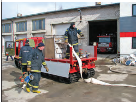
Voolikuliini mahalaotamine Bandwageniga. Sel moel käib töö kuni neli korda kiiremini kui „kondiauruga”.
