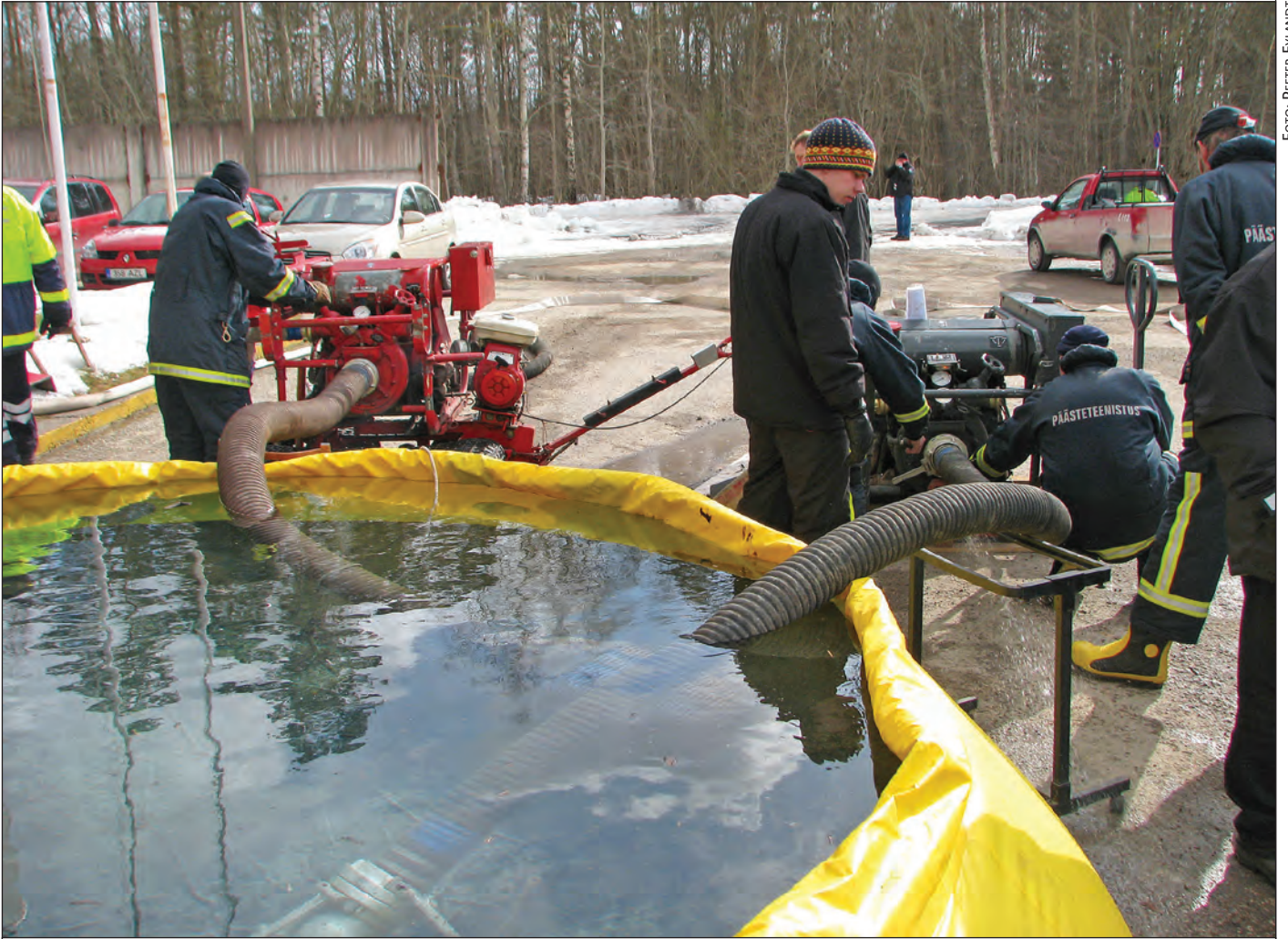
Kui vett on vähe või kui tulekustutamiseks tuleb ehitada hästi pikk voolikuliin, võib vajalikuks osutuda vahebasseinide paigaldamine.
