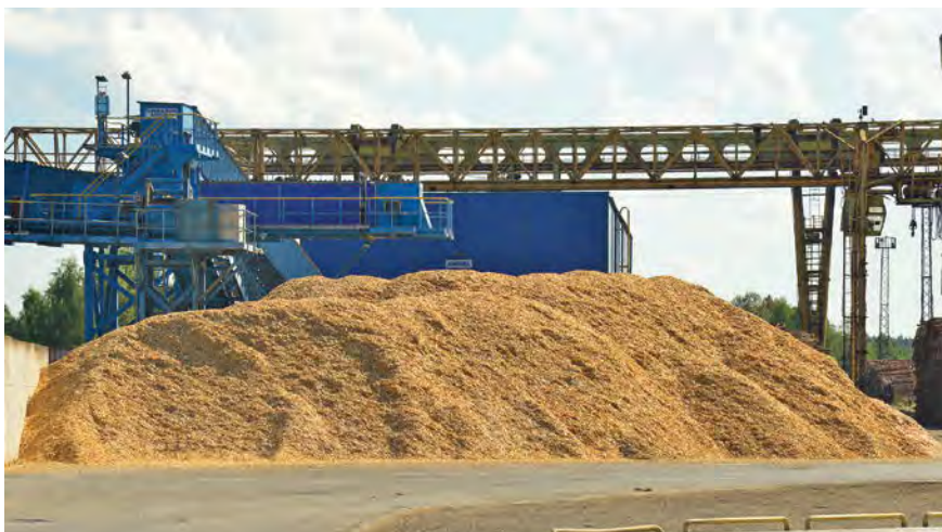
Tselluloosihakke laast peab olema tavalisest pikem ja laastud peavad olema ühtlase suurusega.
