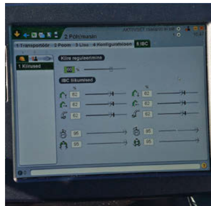
Metsaveotraktori John Deere 1110E kuvarilt on näha, et tõstuki intelligentne juhtsüsteem on sisse lülitatud.
