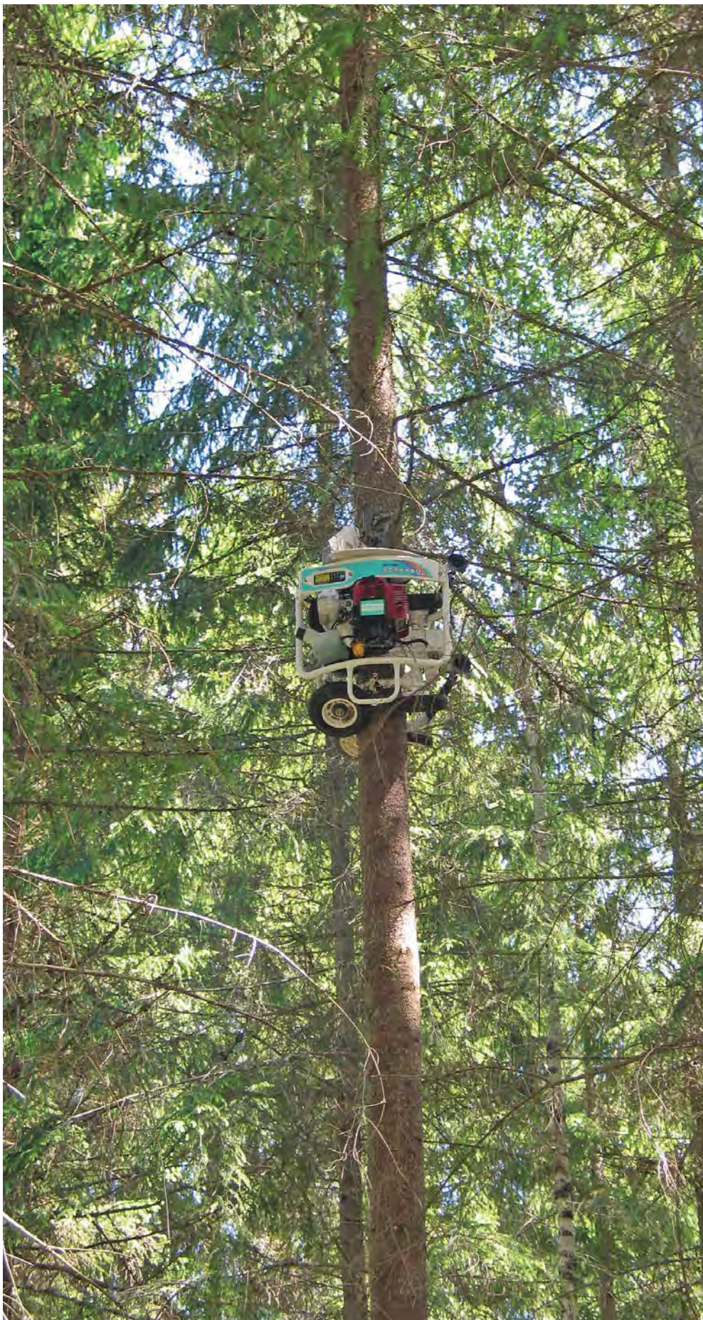
Laasimisrobot Eda-Utsi Yamabiko AB 232R töötamas.
